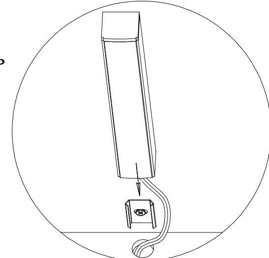
4. Зафиксировать светильник от смещения, натянув провод и намотав его на клипсу для проводов.
