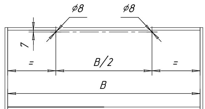
2. Установить крепления для светильника согласно схеме
