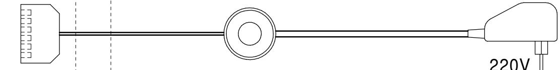
К одной системе 107 можно подключить до 6 светильников (или систем).
