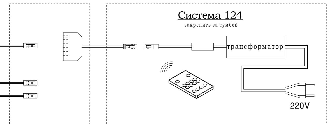
К светодиодному дистанционному выключателю (система 124) можно подключить до 6 светильников (или систем), которые могут включаться и диммироваться (изменять яркость свечения). В случае если в изделиях комбинации 7 и более светильников (или систем), то необходимо использовать систему 99, однако, суммарная мощность светильников не должна превышать рекомендованную максимальную.
