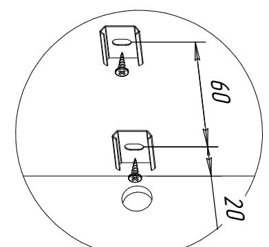
3. Пропустить провод от светильника в отверстие в задней стенке и надвинуть светильник на крепления в плотную к задней стенке.
